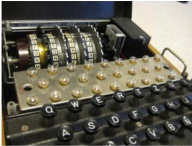
Abb. 4: Enigma der Generation M4. Auf dem Bild sind Tasten, Lämpchen und Walzen zu sehen. Quelle
