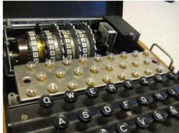
Abb. 4: Enigma der Generation M4. Auf dem Bild sind die Tasten, Lämpchen und Walzen zu sehen. [9]
