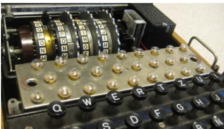
Abb. 1: Enigma der Generation M4. Auf dem Bild sind Tasten, Lämpchen und Walzen zu sehen. (CNET Photos)
