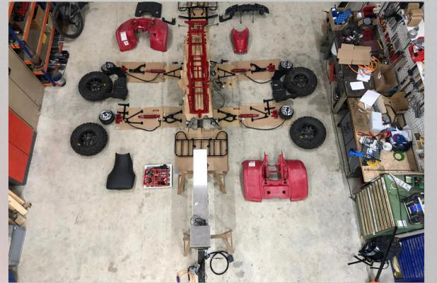
Abb 3: Alle Komponenten des Quads vor dem zweiten Zusammenbau ausgelegt
